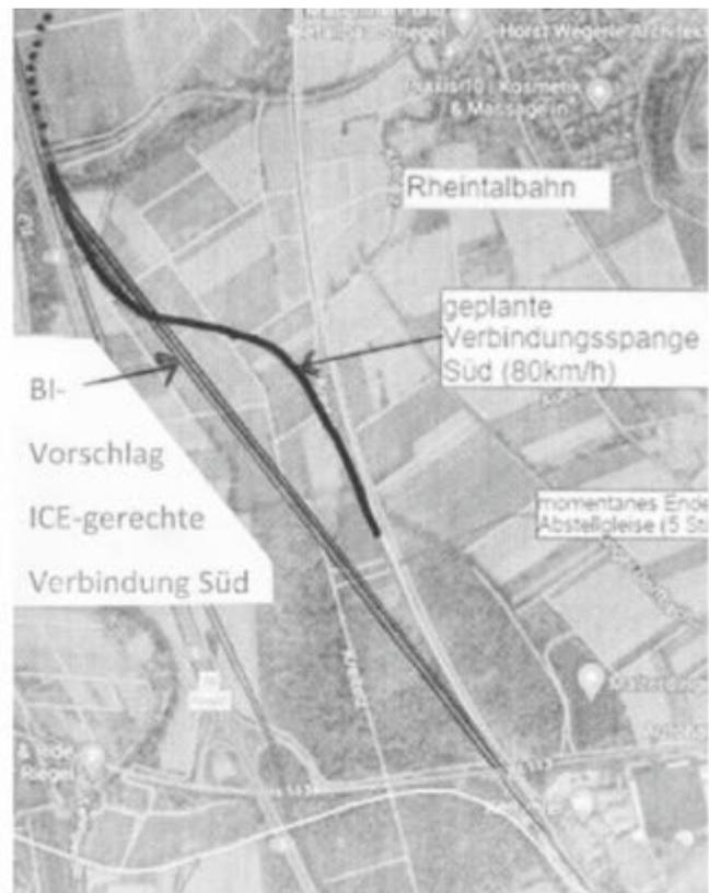
**Gleisen an der Autobahn gebaut werden. Mit der skizzierten „Verbindungsspanne Süd“ (s. oben) der DB Netz AG würde eine S-Kurve beschlossen, die für ICEs wie ein Bremsklotz wirken und einen späteren Beschluss für eine autobahnparallele ICE-Strecke nahezu unmöglich machen würde.**
